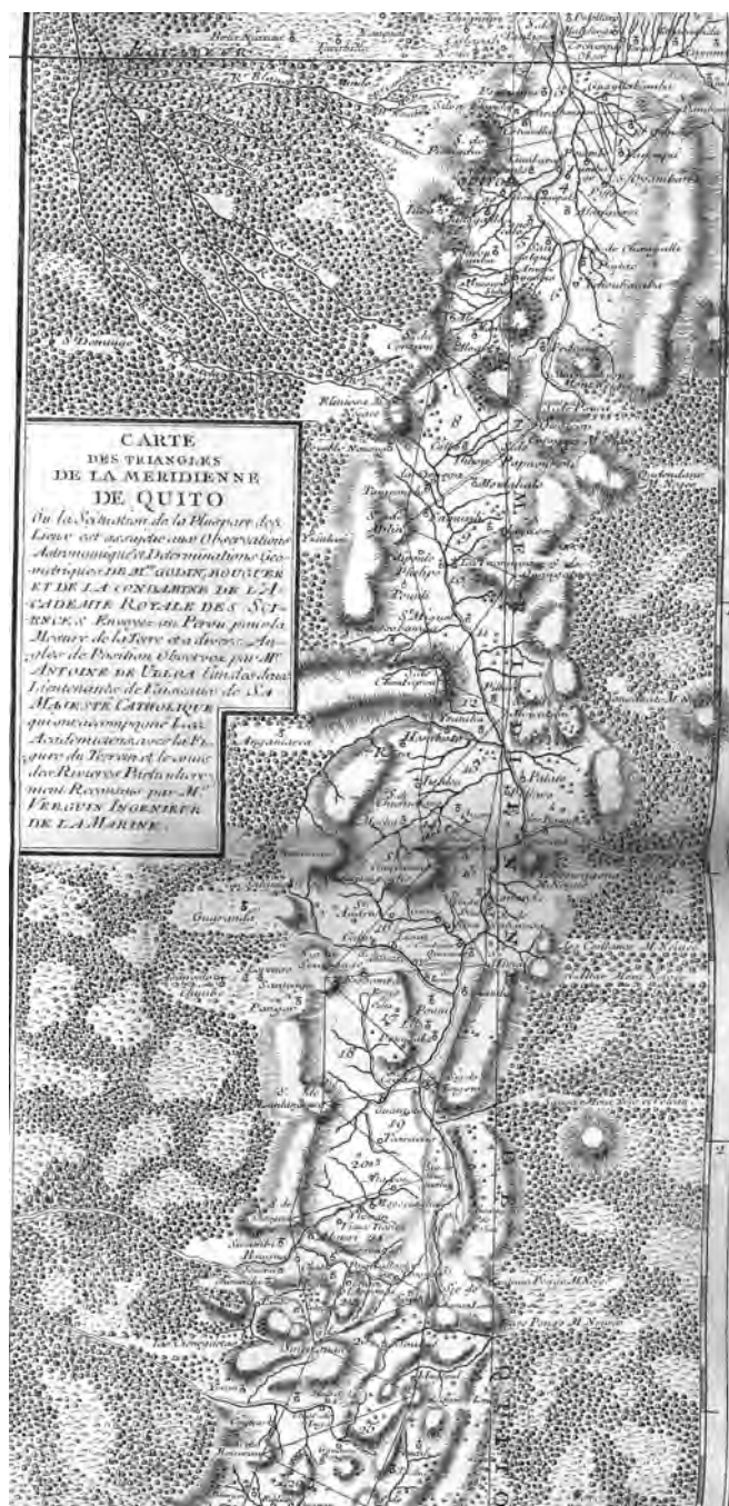
Ил. 5. Карта триангуляционных измерений нулевого меридиана: иллюстрация из книги Пьера Бугера “Фигура Земли, определенная наблюдениями гг. де-ла-Кондамина и Бугера...” (Париж, 1749)
